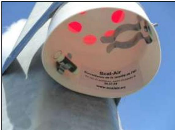
**Figure 2 : Les supports d'éclairage public gérés par EEC et la Ville de Nouméa, ainsi que les poteaux OPT, sont généralement utilisés avec l'accord de ces partenaires pour fixer les boîtes**
